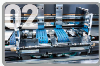
02 底纸部分 Bottom Paper Feeding System
